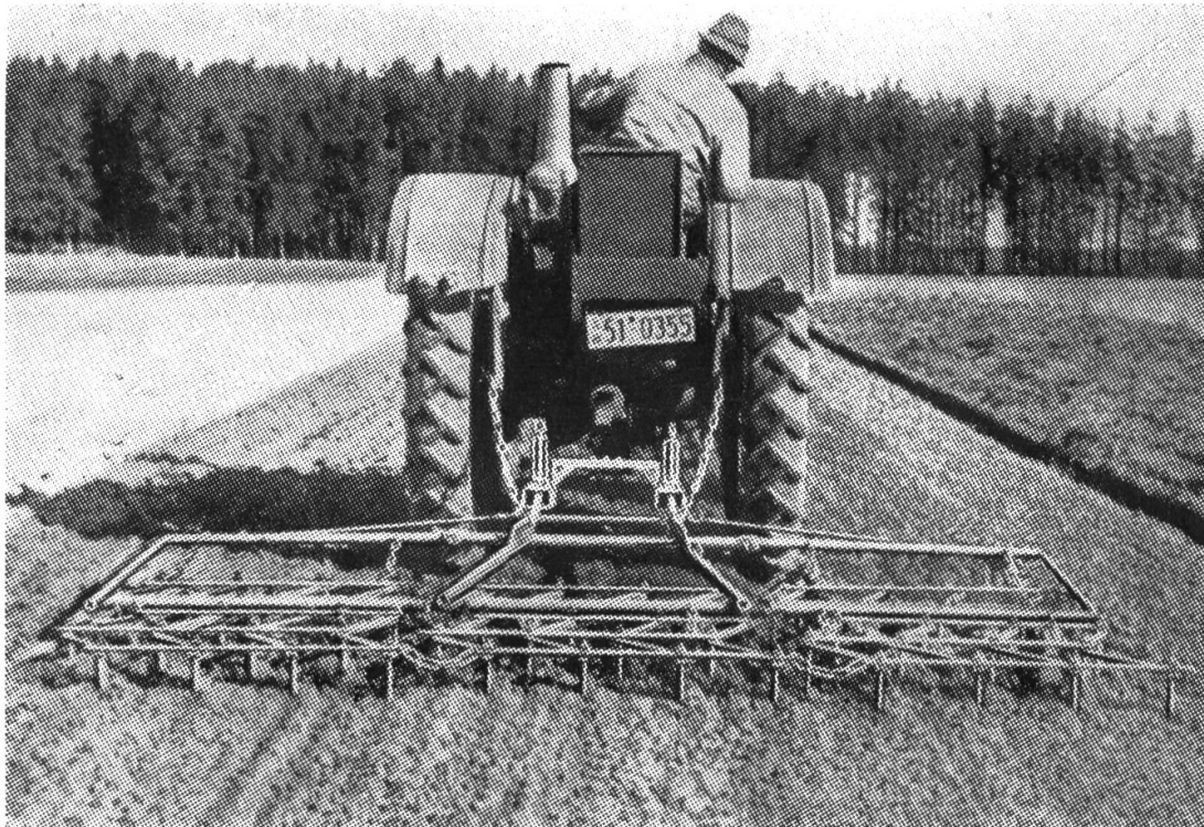
Abb. 6: Lanz-Allzweck-Traktor mit gekoppelter dreifeldriger Egge. Die Egge kann hydraulisch angehoben werden. Beachtenswert ist die Anhängervorrichtung (Eberhardt) an die auch Pflug, Kultivator usw. passt und für jedes Traktorsystem verwendbar ist.
