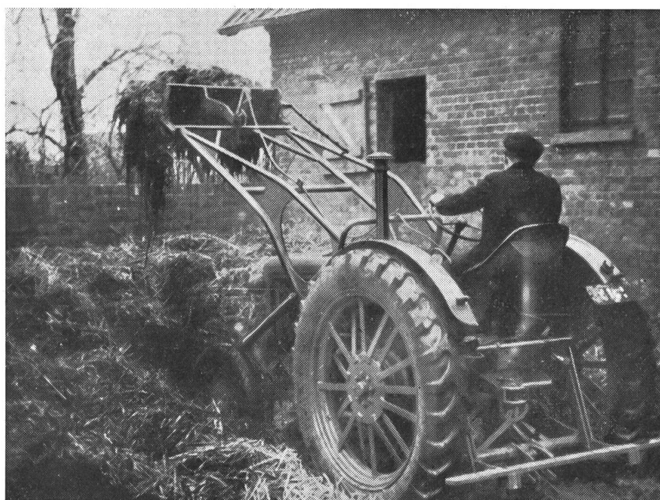
Abb. 8: Der deutsche Wittenburg-Lader am Hanomag-Schlepper R 25.
