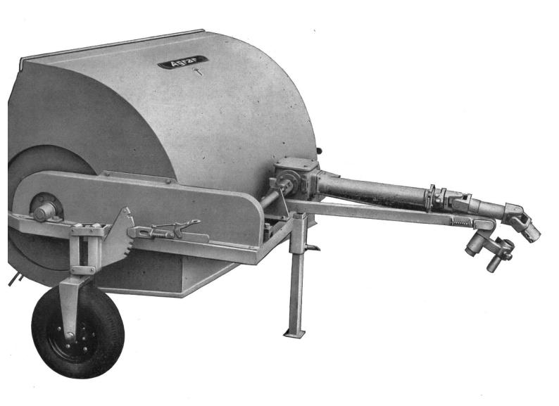
eignet sich zum Anschluss an alle Traktoren mit normalisierter Zapfwelle.
