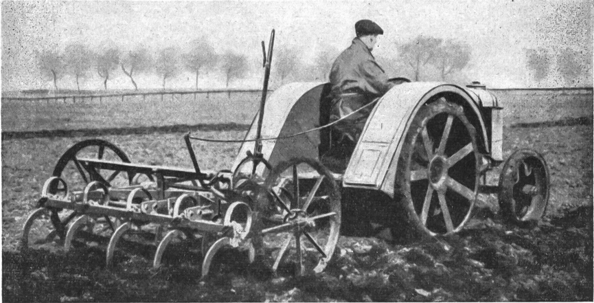
Man beachte die tief hinunter gezogenen Kotflügel, die verhüten, dass Bekleidungsstücke des Führers oder auf dem Trittbrett stehender Personen von den Triebrädern erfasst werden.
