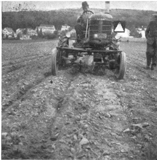
Abb. 1a: «Farmall A» beim Tieflockern
