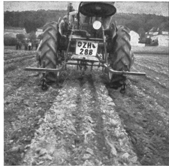
Abb. 1b: «Farmall A» mit Spurlockerern ausgerüstet
