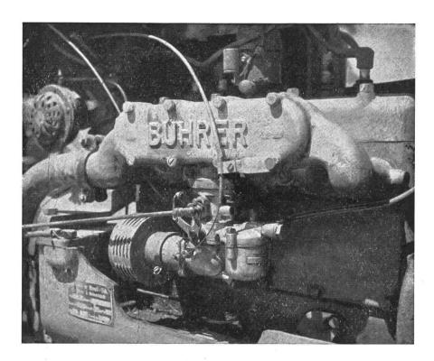
Petrol- und White-Spirit-Vergaser mit Erhitzung des Gasgemisches im Auspuffkollektor Dieser Vergasertyp besitzt ein in das Auspuffrohr ein- oder an dieses angegossene Ansaugrohr. Durch die austretenden heissen Auspuffgase wird auch das Ansaugrohr derart erhitzt, dass sich der Treibstoff-Nebel darin zu brennbarem Gas verwandelt. Zahlreiche Petroltraktoren sind mit diesem guten Vorwärmungssystem versehen.
