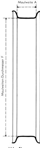
**Abb. 4b:** Dimensionierung der Flachbettfelge.
