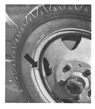
**Abb. 3:** Flachbettfelge mit Sprengringsicherung.
