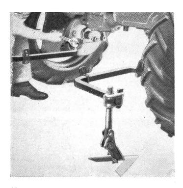
Der Spurlockerer an den Farmall-Traktoren.
