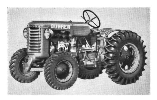
Traktor Bührer, Mod. BD-3, mit 3 Zylinder-Dieselmotor. Typischer Vertreter eines Schweizer Dieseltraktors.
