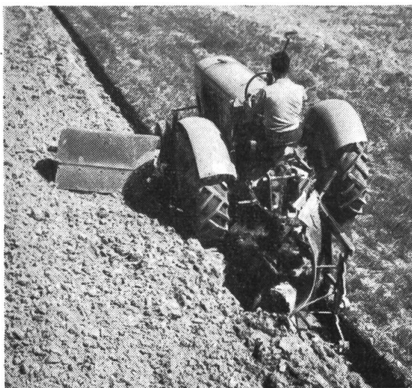
Traktor «Vevey-Diesel», Typ 560, mit Anbau-Wendepflug «Henriod» und seitlicher Fräsegge.
