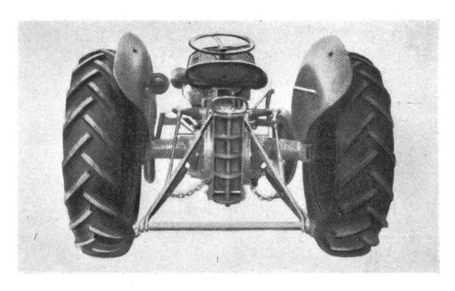
«Ferguson»-Traktor mit dem hydr. betätigten Gestänge für den praktischen Anbau der Geräte.
