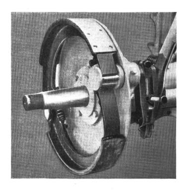
Radbremse an den Traktoren «Hürlimann».
