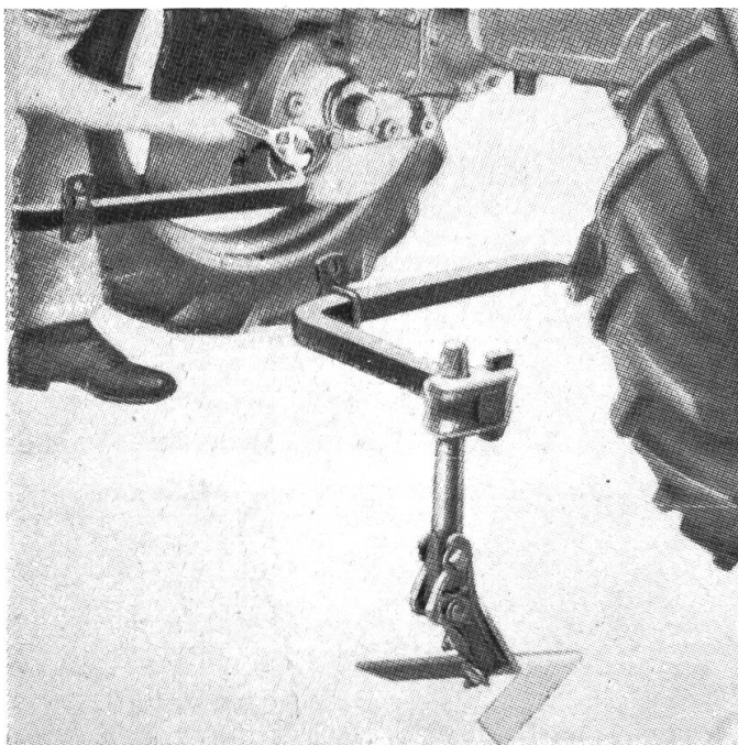
Der Spurlockerer an den Farmall-Traktoren.
