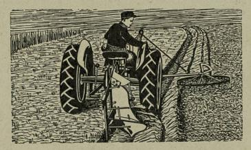
der Furche eine konstant gleiche Furchentiefe gewährleistet ist. Dadurch war es mir möglich das Pfluggewicht zu senken ohne an der Solidität einzubüssen, weil der ganze Pflug aus bestem, zu diesem Zweck geeignetem Stahl-Material geschmiedet wird. Auch der Preis hat eine bedeutende Reduktion erfahren. - Alle Einmann-Stahl-Pflüge Vogel werden mit 2teiligen Vorschäler geliefert, die Ersatzschneiden werden mit zwei Schrauben ausgewechselt. Meine Panzerstahlriestern, cylin-
