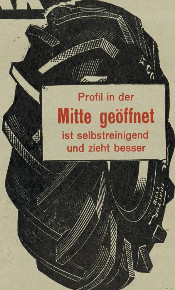
GOODYEAR Traktorenreifen wurden von den grössten amerikanischen Versuchsanstalten den härtesten Proben unterzogen. Das „SURE GRIP“ Profil – in der Mitte unterbrochen – erwies sich als das beste. Sein Zugsvermögen ist grösser als das bei Reifen mit geschlossenen Stollen. Montieren Sie GOODYEAR „SURE GRIP“ Reifen auf Ihren Traktor!
