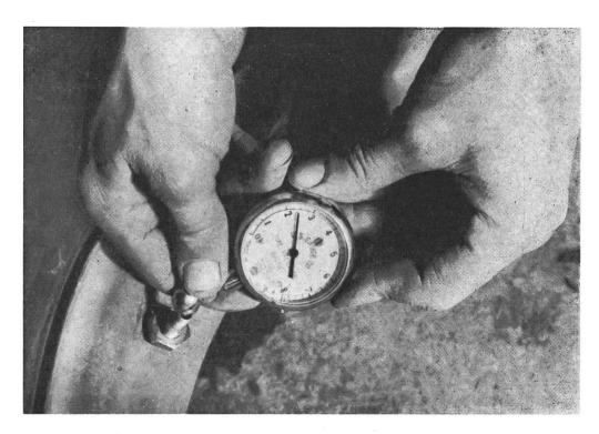
Abb. 1 Kontrolle des Pneudruckes nach der Montage.
