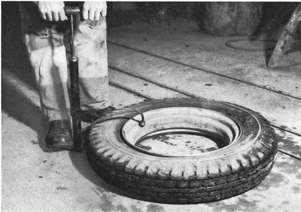
Abb. 15. Leichtes Aufpumpen des Pneus. Kontrollieren, ob er richtig in der Felge sitzt. Nachher Aufpumpen auf den richtigen Pneudruck (siehe Tabelle auf Seite 4).
