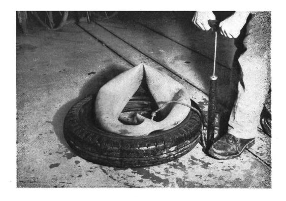
Abb. 10. Leichtes Aufpumpen des Schlauches.
