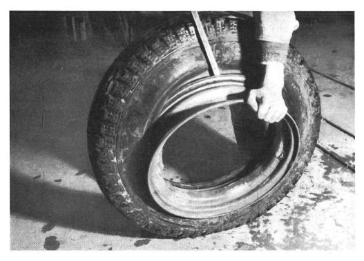
Abb. 6. Entfernen des Pneus von der Felge.
