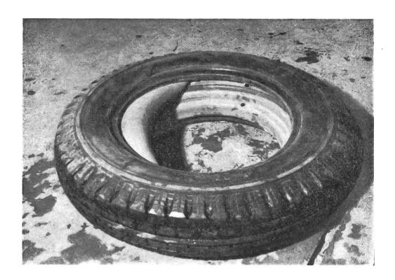
Abb. 13. Sorgfältiges Einschieben des Schlauches.
