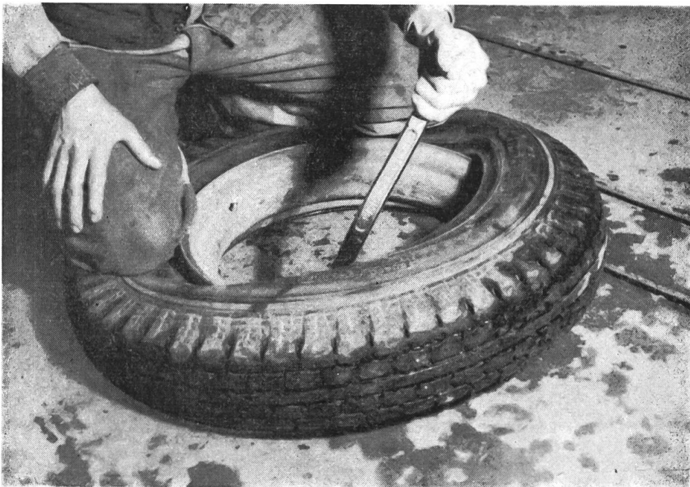
Abb. 14. Beginn des Einlegens der zweiten Pneuseite beim Ventil. Festhalten mit den beiden Knien im Tiefbett und durch sorgfältiges Nachgreifen mit der abgekröpften Seite des Pneuhebels. Beendigung der Montage. Es muss bei dieser Arbeit sorgfältig vorgegangen werden, damit die Drahteinlage des Pneus nicht beschädigt wird.
