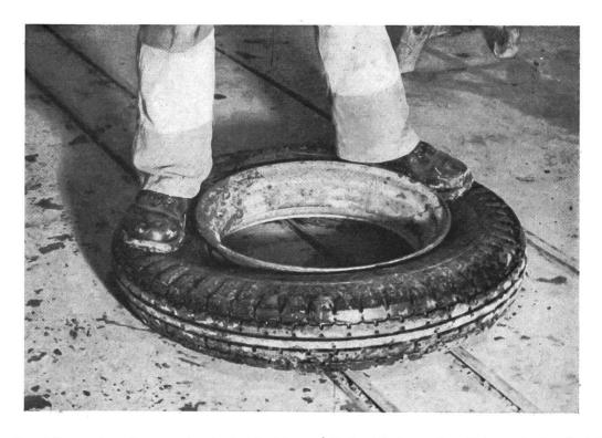
**Abb. 3.** Lösen des Pneus durch beidseitiges Niederdrücken der Seitenwände (möglichst nahe an den Felgen).
