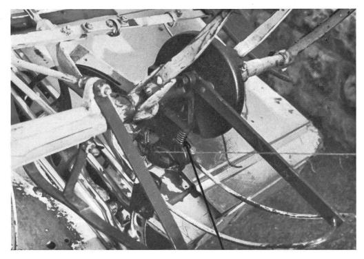
Das Festhalten des Bindegarnes wird reguliert durch die Klemmbackenfeder (Abb. 29). Diese ist so zu spannen, dass die Schnur nicht zerquetscht wird, jedoch bei ziemlich starkem Zug, unter dem Backen hervor gezogen werden kann. Zu geringes Klemmen hätte zur Folge, dass sich die Schnur schon während der Bildung der Garbe löst, nicht erst bei deren Auswerfen durch die Auswerfarme.
