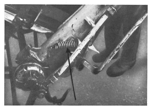
Abb. 28 Sperrarmfeder zur Regulierung der Bundfestigkeit.
