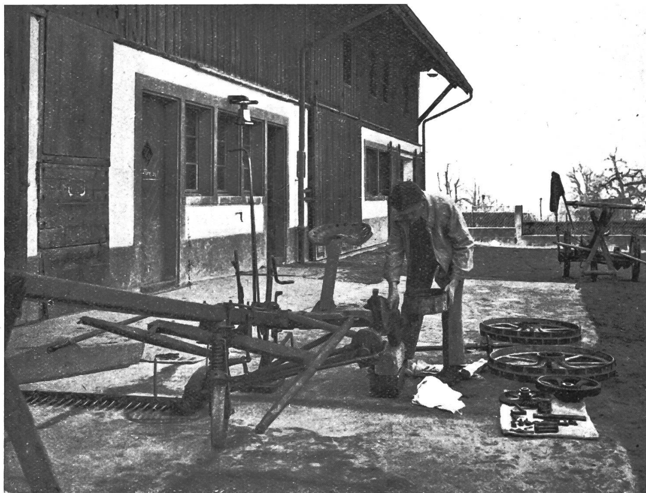
Abb. 1: Gründliche Revision und Reinigung einer Mähmaschine
