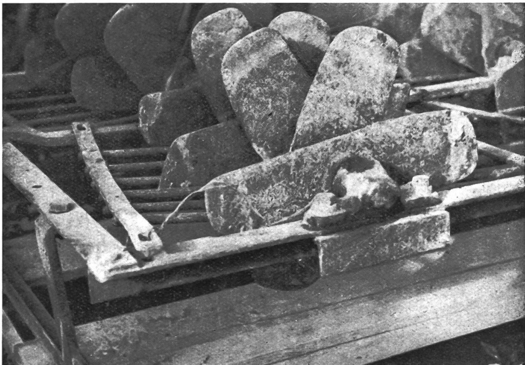
Abb. 12: Spaten zu kurz, stumpf und Abstreicher mit Draht befestigt.
