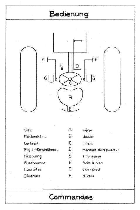
Abb. 7: Verteilung der Bedienungshebel,
