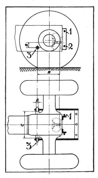
Abb. 6: Befestigungsmöglichkeiten für die Aufbaugeräte.
