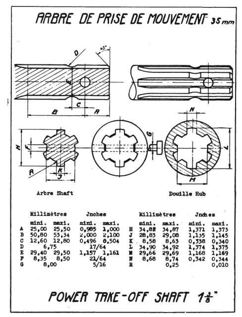
Abb. 1: Die normalisierte Zapfwelle, «SAE Norm 6 B», ihre Form und ihre Abmessungen.
