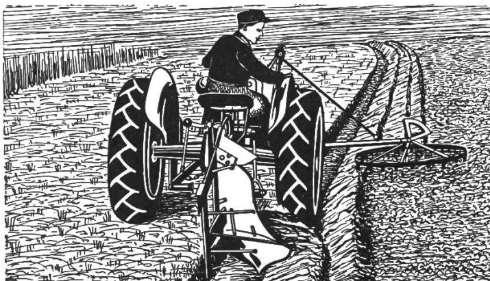
Handaufzug, Zapfwellenaufzug und hydraulischer Aufzug: Keine Reparatur. Ganzstahlkonstruktion: Keine Gussteile. Automatisches Wenden: Mit Feder, zuverlässig, seit 5 Jahren von mir konstruiert. Tiefenmomentverstellung: Kein Anthaupt. Beweglicher Pflugkörper: Passt sich dem Gelände an. Langes, breites Haupt: Gibt dem Pflug Halt und Führung. Zusammengeschweißtes Säch: Keine versteckten Pflugkörper od. abgerissene Wägissen. Keine Reparaturen.
