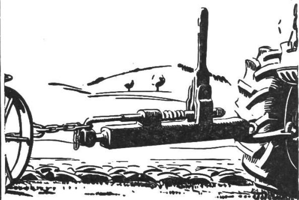
**Automatischer Ausklinker für Traktorpflug**
