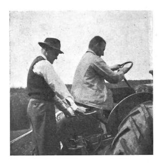
Bequeme und robuste Haltevorrichtung für Mittahrer am Traktor «Case» VS (Allamand Ballens).
