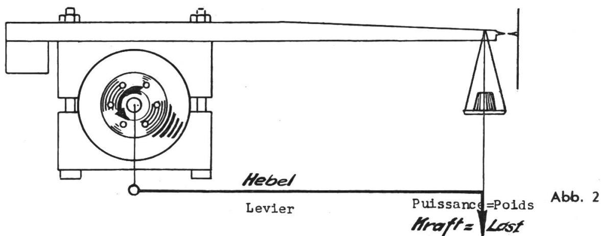
Eine Trommel wird an das Schwungrad angeflanscht. Zwei Bremsbacken können mittels Schraubenzug mehr oder weniger fest angeklemmt werden. An diesen Backen ist ein Hebelarm befestigt, der aussen mit Gewichten belastet werden kann. Aus der Hebellänge (l), dem Gewicht (P) und der Motordrehzahl (n) kann die Motorleistung errechnet werden.
