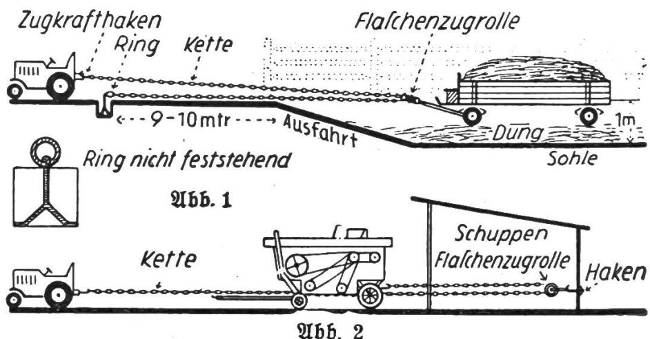
gehängt. Das eine Ende wird in dem Ring befestigt, an das andere Ende wird der Traktor gehängt. Der Traktor hat dann einen festen, trockenen Untergrund. Der Wagen wird dann spielend leicht hinausgezogen. Einen besonderen Vorteil hat der Flaschenzug beim Anziehen des luftbereiften Traktors noch deshalb, weil sich auf der Sohle und Ausfahrt der Mistablage die Profile der Gummiräder meistens mit dem speckigen Stalldünger verstopfen.
