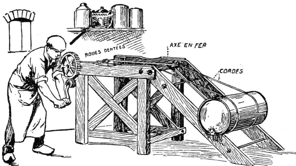
Il consiste en un dispositif de treuil fixé à une des extrémités du chevalet. Une grande roue de transmission est clavée à une extrémité du treuil et une petite roue s'engrène avec elle, comme il est indiqué. A la petite est fixé une poignée destinée à donner un mouvement de rotation.
