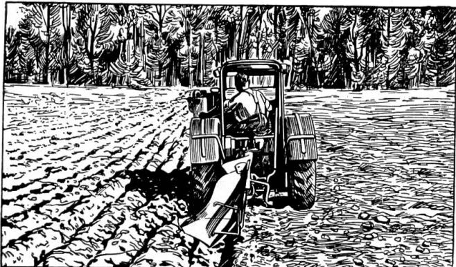
und automatisch gewendet. Keine Ermüdung des Traktorführers. Die Tiefenregulierung gewährleistet auch am Anfang und Ende der Furche gleichmässige Tiefe. Aufwärtpflügen: garantiert jedes Gelände. Montage: mit Stecknagel, nur 1 Mann nötig. Der hydr. Aufzug erfordert keine Kraftanstrengung und ermüdet den Traktorführer nicht.
