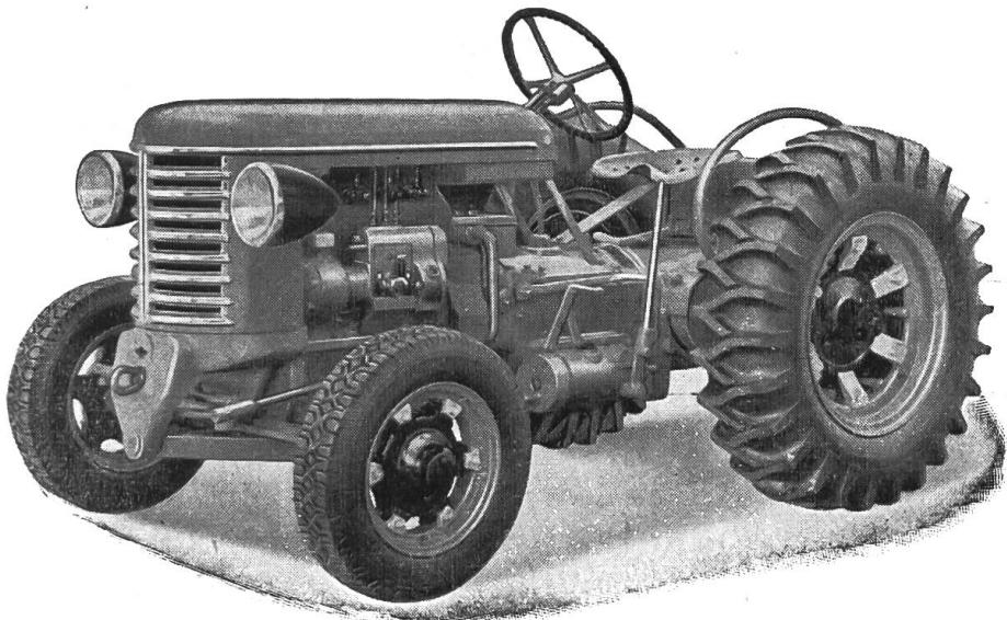
Zentrale Zapfwelle - 7- oder 8-Gang-Getriebe und
