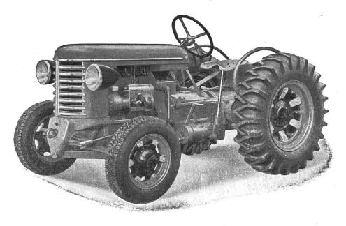
Zentrale Zapfwelle - 7- oder 8-Gang-Getriebe und verschiedene weitere Neuerungen sind die Hauptmerkmale des Bührer-Diesel 1945
