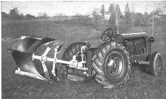
Motrac mit automatischem, durch Motor betriebenen Einmannpflug. - Tiefeneinstellung vom Führersitz aus.
