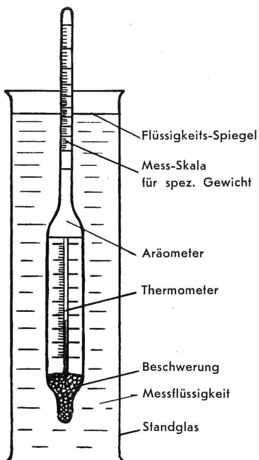
Aräometer sind, wie die Skizze zeigt, Spindeln, die an einem Ende beschwert in der Probeflüssigkeit schwimmen.
