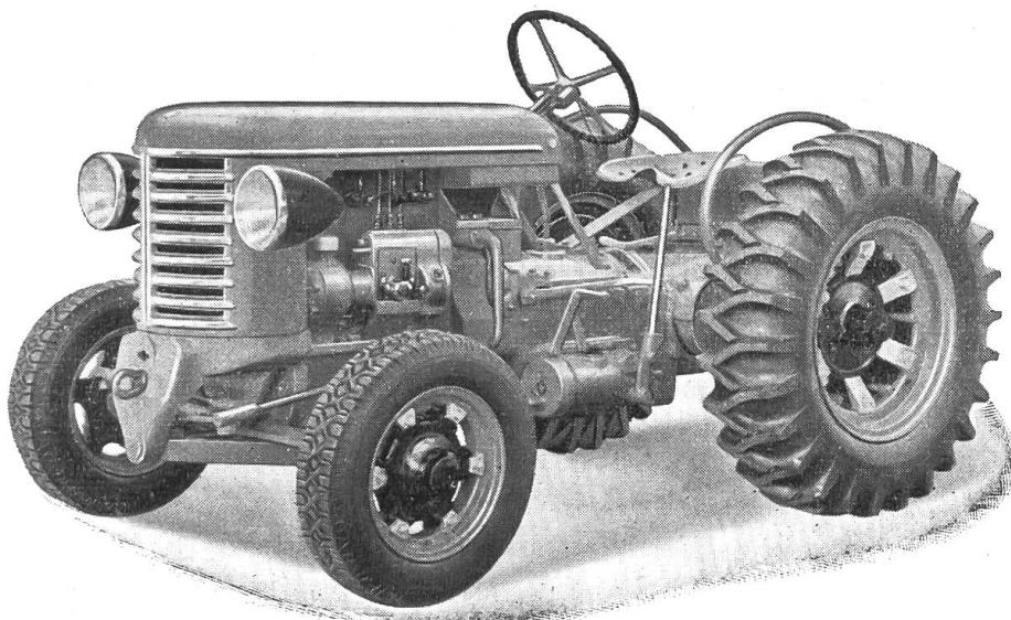
Zentrale Zapfwelle - 7- oder 8-Gang-Getriebe und
