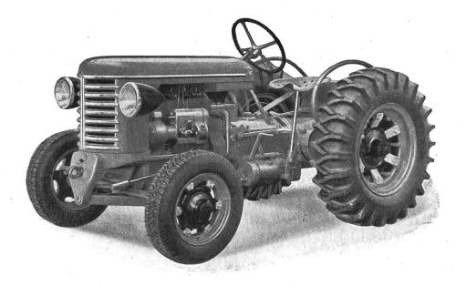
Zentrale Zapfwelle - 7- oder 8-Gang-Getriebe und verschiedene weitere Neuerungen sind die Hauptmerkmale des Bührer-Diesel 1945
