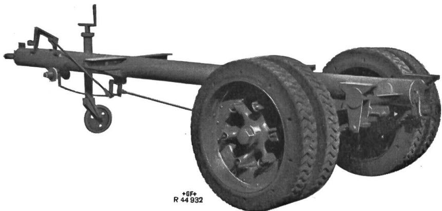
für Vollgummi und Luftbereifung (auswechselbar)
