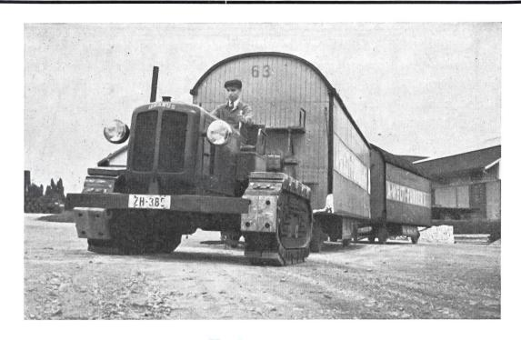
Uranus Rollenbahn-Traktor zugsicher - geländegängig
