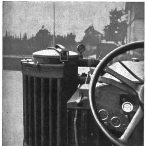
gewissen Betriebszuständen abgeben, den Filter ungehindert passieren, um sich später in den Rohrleitungen oder im Gasluftmischer zu kondensieren. Grössere Mengen Teer, wie sie z.B. beim Durchfressen eines Herdmantels auftreten, hält das Filtertuch in den meisten Fällen zurück und verhindert somit ein Verteeren des Motors.
