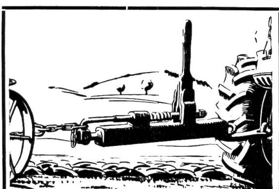
**Automatischer Ausklinker für Traktorpflug** + Pat. 201.877
