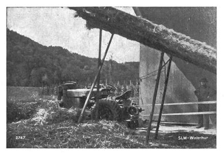
Holzgasgenerator eigener bewährter Bauart Kapazität ca. 40 kg Holz
