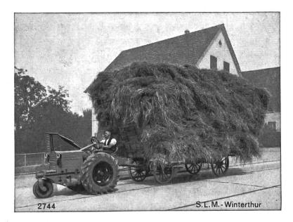
Vorderradsteuerung und unabhängige Differentiallenkung der Triebräder
