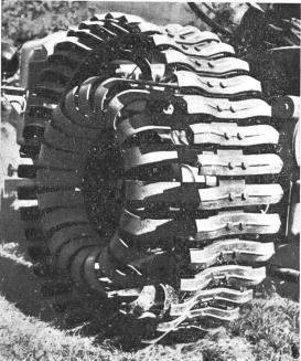
Die gemachten Zugversuche beweisen eindeutig, dass die Adhäsion des Rades beim Pflügen keineswegs hinter dem Pneurad zurücksteht, sondern bei nassem Wetter noch wesentlich zu übertreffen vermag. Als überraschender Erfolg darf die Schonung der Grasnarbe angesprochen werden.
