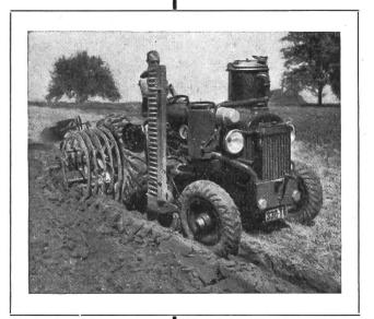
der Egge-Arbeit mit der Rotax-Traktoregge ausgeführt während des Pflügens, also im gleichen Arbeitsgang, zeigt sich im guten Saatenstand zufolge Bewahrung der Bodenfeuchtigkeit.
