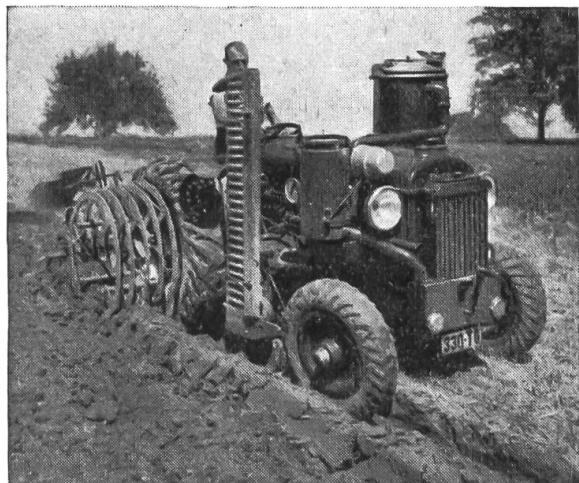
der Egge-Arbeit mit der **Rotax-Traktoregge** ausgeführt während des Pflügens, also im gleichen Arbeitsgang, zeigt sich im **guten Saatenstand** zufolge Bewahrung der Bodenfeuchtigkeit.
