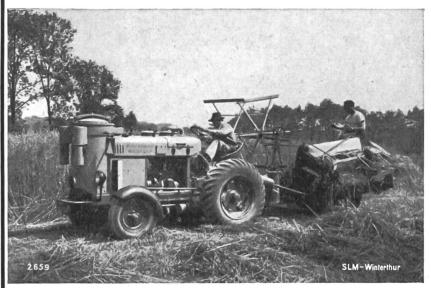
Holzgasgenerator eigener bewährter Bauart Kapazität ca. 40 kg Holz
