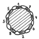
Fig. 4: Reihenfolge der Auffragungen auf einer Welle zum Verformungsausgleich.
