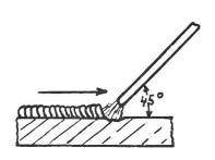
Fig. 3: Schweissrichtung in der Elektrodenneigung.
