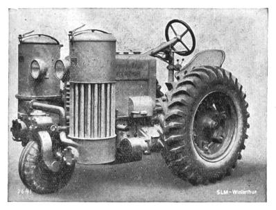
Vorderradsteuerung und unabhängige Differentiallenkung der Triebräder
