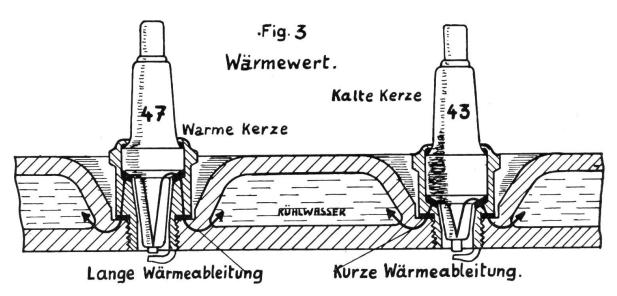
diese Kerze Selbstzündungen. Bei zu kalter Kerze überzieht sich der Isolatorfuss mit Oelkohle. Dieser bildet für den Zündstrom eine Ableitung (Kriechweg) an die Masse, wodurch der betreffende Zylinder im Betrieb aussetzt. Das Ver-
