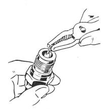
Fig. 5 Nur die Massen-Elektrode biegen.
