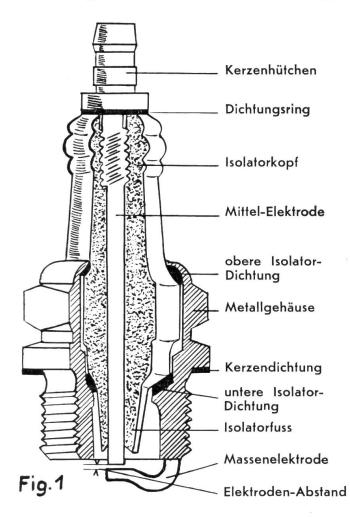
Anforderungen: Die Zündkerze ist elektrisch, mechanisch und thermisch sehr hoch beansprucht; Elektrisch, weil sie Spannungen von 15,000 Volt isolieren muss; Mechanisch, indem sie Explosionsdrücken von 40 Atm. widerstehen muss; Thermisch, indem sie innerhalb Bruchteilen von Sekunden Temperaturwechsel von 0—2000 Grad ausgesetzt ist.
