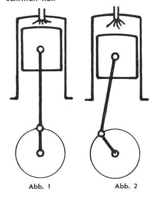
Die zuerst beschriebene Zündungs-Art (Kolben genau im obersten Punkt) nennt sich Spätzündung (s. Abb. 1). Die zweite Zündungs-Art (Kolben hat den obersten Punkt noch nicht erreicht) nennt sich Frühzündung (s. Abb. 2).
