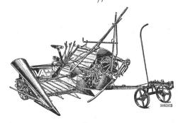
Seine einzigartige Stabhebevorrichtung ermöglicht das Mähen gelagerter und verwirbelter Frucht auf allen vier Seiten eines Feldes und das Binden in einwandfreie Garben wie beim stehenden Gewächs. SA 3258 B
