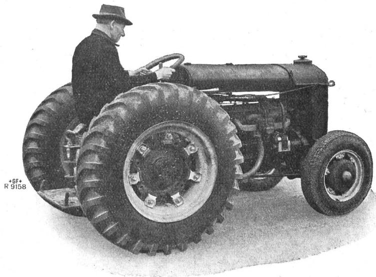
mit den Mitte geteilten leicht montierbaren Tiefbettfelgen in Verbindung mit dem griffigen Niederdruckreifen machen den Traktor zu der bevorzugten Zugmaschine.
