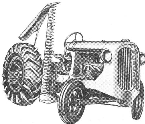
ist technisch vollkommen und praktisch konstruiert; kleinster Rank. Dem rassigen starken Motor steht das richtige Gesamtgewicht des Traktors von ca. 1800 kg gegenüber. Bei grösster Leistung sehr sparsam im Betrieb. Mähapparat mit vollautomatischer Auskupplung, Einzelradabbremsung und viele andere Vorteile. Zweckmässige Luftbereifung, Anlasser, Licht etc. Einfach, solid und zäh. SA 9120 A
