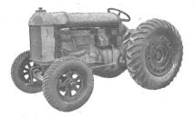
Umbau von Ackerrädern auf Luftbereifung
