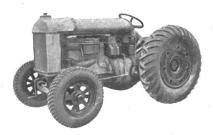
Umbau von Ackerrädern auf Luftbereifung
