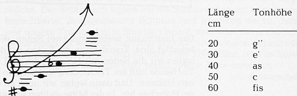
Wir sehen, die Kurve wird immer steiler. Die Töne liegen immer weiter auseinander, obschon die Holzlänge gleichmässig abnimmt. Aber: 60 zu 50 ist ein anderes Verhältnis als 30 zu 20. Was heisst das für den Bau eines Xylophones?
