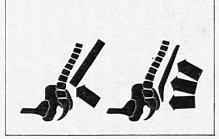
Die Wirbelsäulenform wird massgeblich durch die Stellung des Beckens bestimmt. Die neue Rückenlehne beeinflusst direkt die Becken-stellung durch Abstützung der Kreuz- und Lendengegend. Unangenehme Druckpunkte werden vermieden.
