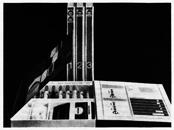
In der dreiteiligen Schulkollektion wird die Entstehung von Viscosefasern (Rayonne, Fibranne), Polyamidfasern (Nylon) und Polyesterfasern dargestellt. Die einzelnen Stufen der Fabrikation (Rohstoffe, Zwischenfabrikate) und die verschiedenen Garntypen werden anhand von Mustern anschaulich gezeigt. Eine kleine Musterkollektion weist auf die vielseitigen Einsatzgebiete von Chemiefasern hin.
