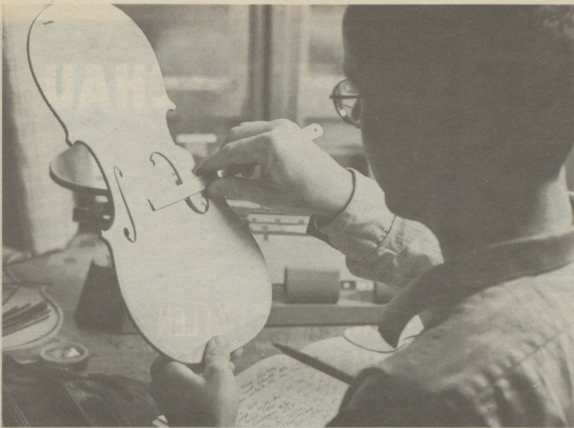
Einmessen des Bassbalkens in die fertig ausgearbeitete Geigendecke.
