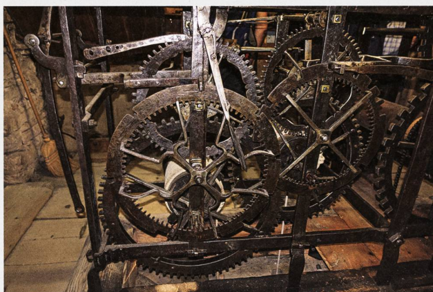
Das Zentraluhrwerk im ehemaligen Kloster Neu St. Johann: Feinmechanik für die Steuerung des Glockenschlags und über 200 Meter Gestänge für alle Uhren im Kloster.
